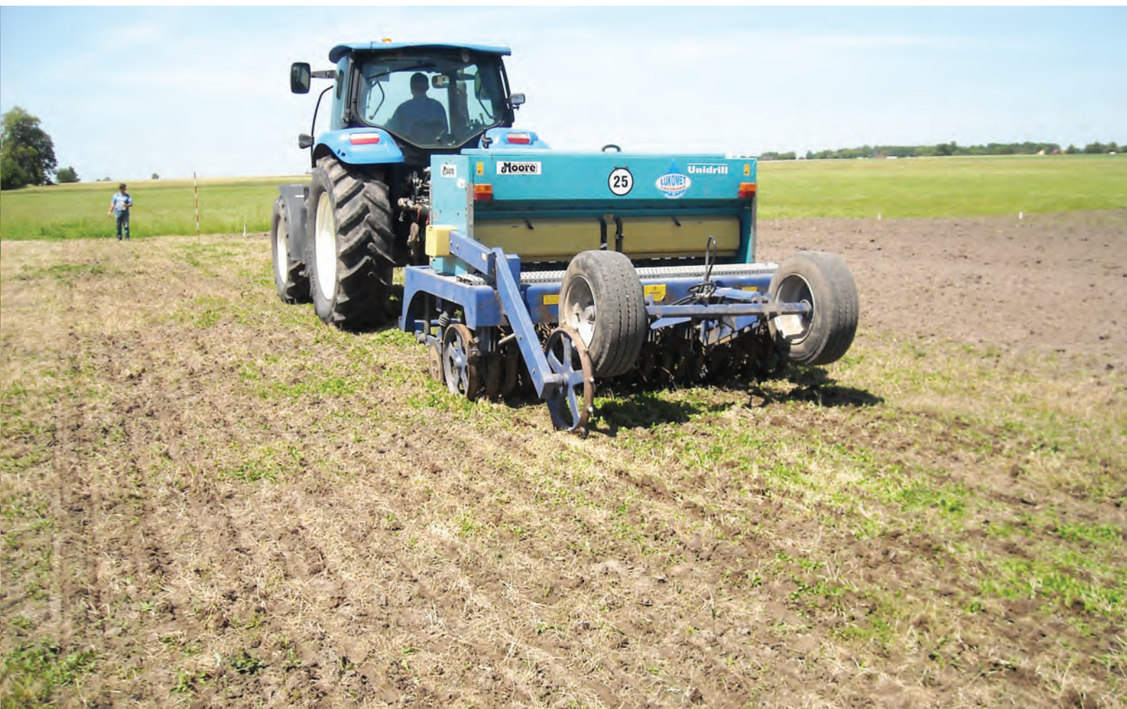
Fot. 3. Siew bezpośredni mieszanek bobowato-trawiastych siewnikiem szczelinowym po zahamowaniu wzrostu starej runi herbicydem
